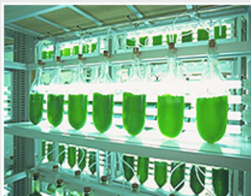
Биореактор для производства водорода из водорослей
