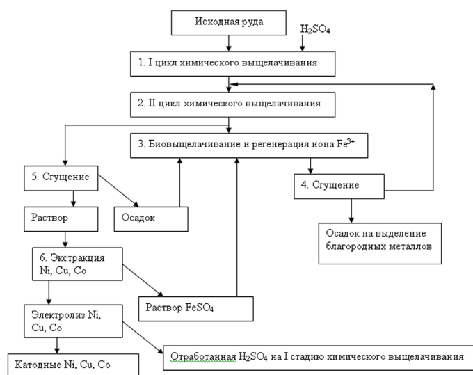
Рис. 7. Принципиальная технологическая схема с применением двухстадийного бактериально-химического выщелачивания
