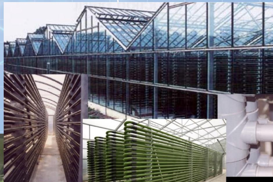
**Вертикальный фотобиореактор** с освещением снаружи и внутри слоя культивирования. Освещение внутри слоя обеспечивается за счет оптоволоконного бокового свечения, что позволяет достичь больших концентраций биомассы по сравнению с другими вариантами
