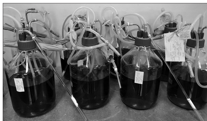
Рис. 1. Сборное изделие с питательной средой для культивирования микроорганизмов
