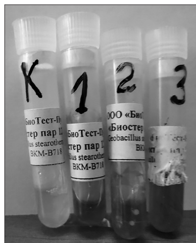
Рис. 6. Контроль эффективности режима стерилизации биологическими индикаторами. К — АБИ контроль, 1 — АБИ из трубки вне бутылки; 2 — АБИ из трубки в полости бутылки, 3 — АБИ со дна бутылки
