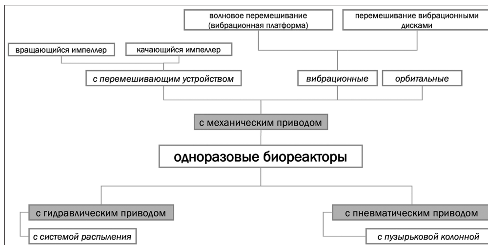
Рис. 5. Классификация одноразовых биореакторов по механизму передачи энергии
